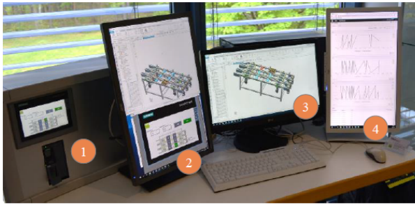
Abbildung 5: Darstellung der Hil unter Verwendung einer realen Steuerung mit einem Human-Machine-Interface (HMI) und einer Simulation-Unit (1) und der SII mit einer simulierten Steuerung, simuliertem HMI (2) und dem multiphysikalischen Modell (3) im MCD, sowie beispielhafter, cloudbasierter Visualisierung von Produktionsdaten.
